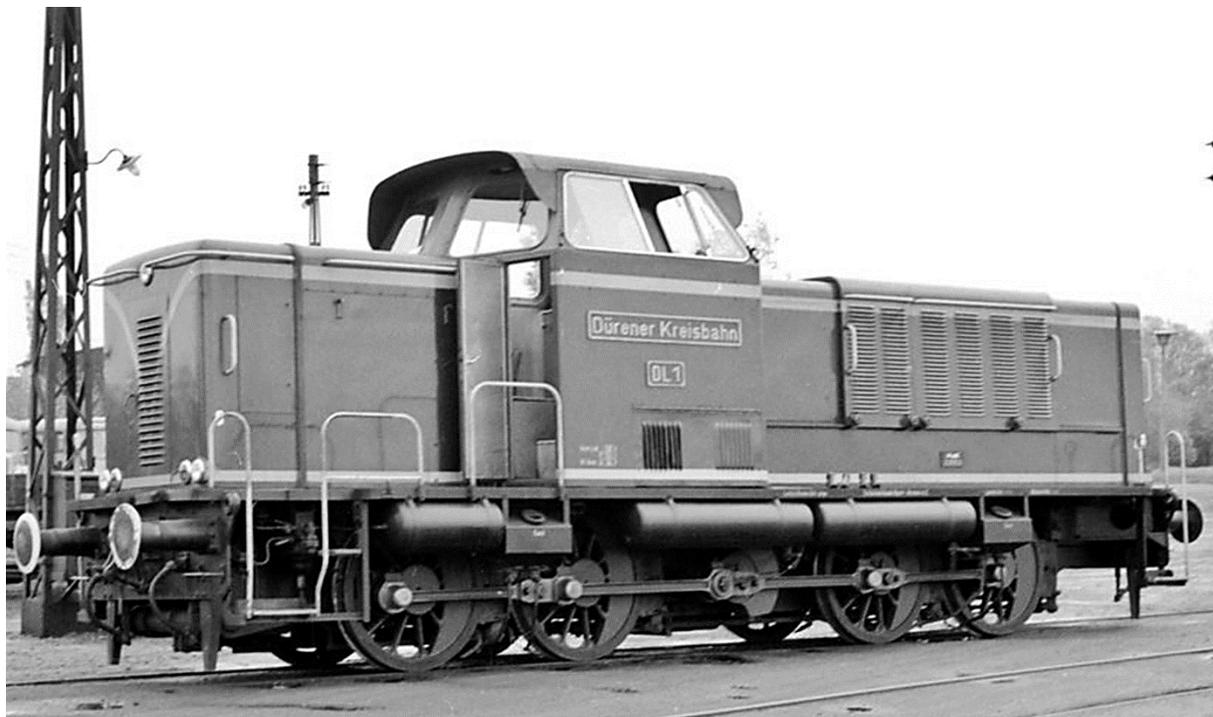
Diese von der „Maschinenbau Kiel Aktiengesellschaft“ gebaute Diesellokomotive mit einer Leistung von 600 PS war eine Mehrzweck-Lokomotive, die sowohl im Rangierdienst bis 36 km/h und im Streckendienst bis 60 km/h eingesetzt werden konnte.
