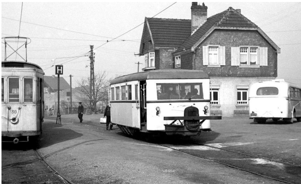
Am **02. November 1938** wurde ein neuer Triebwagen in Dienst gestellt. Es war ein Schienenbus aus dem "Werk Wismar" mit einem Ford-Vorba-Motor für die Strecke Nörvenich-Zülpich-Embken. Die Kosten betragen 39.000 Reichsmark. 1941 wurde ein weiterer Schienenbus des gleichen Typs (VT2) eingesetzt. Das Fahrzeug wurde wegen seines "Vorbaus" liebevoll von der Bevölkerung " Schweineschnäuzchen" genannt.
