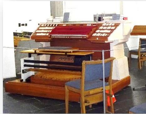
Über der Taufkapelle befindet sich eine beeindruckende Orgel (unten) mit Trompeteria des Herstellers Orgelbau Weimbs aus Hellenthal. Das Werk wurde auf rein elektrische Steuerung umgebaut. Der Spieltisch steht in der Annokapelle. Sie enthält 47 Register, verteilt auf drei Manuale und Pedal.
